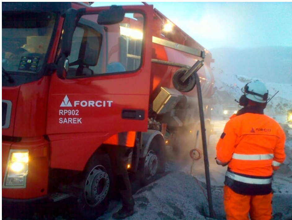
Bild 49: Laddtruck under arbete med mobil tillverkning av sprängämne. Foto: Forcitr AB.
