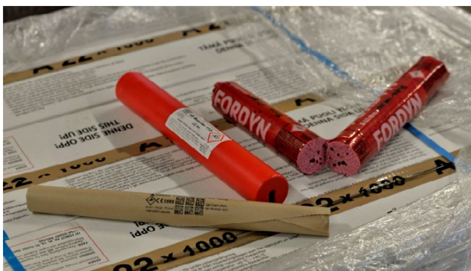
Bild 3: Patroner med sprängämne: dynamit och blandsprängämne.
