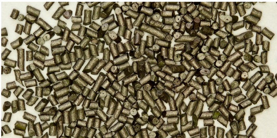
Bild 9: Krutkorn i förstoring. Foto: Ingemar Malmström.
