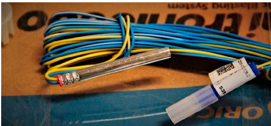
Bild 5: Sprängkapsel med elektrisk tändning.
