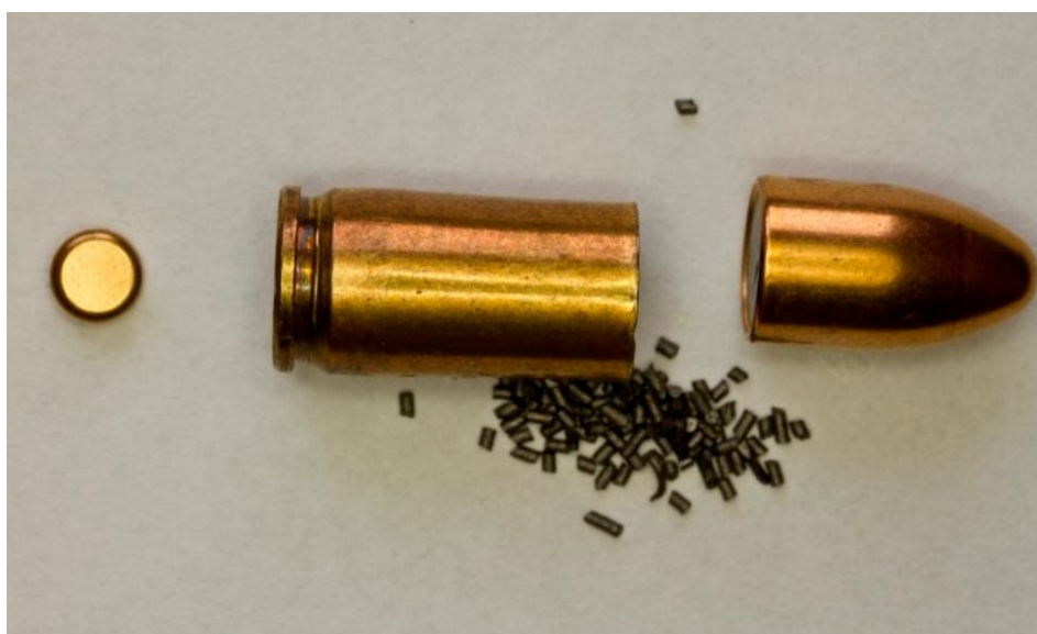
Bild 14: Komponenter i en patron. Foto: Ingemar Malmström.
