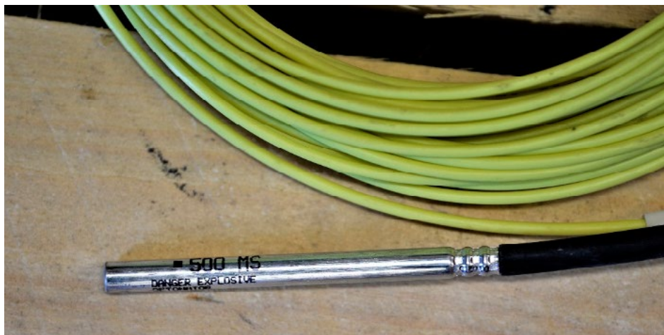
Bild 6: Sprängkapsel med icke-elektrisk tändning.
