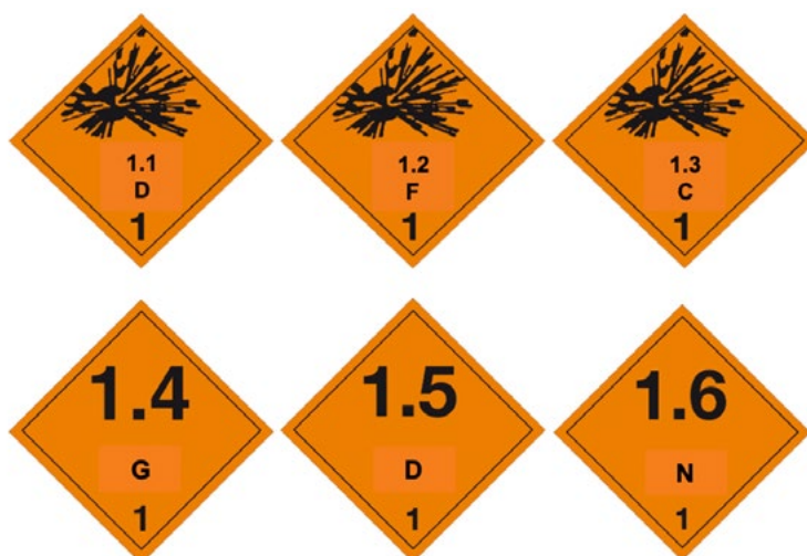
Bild 16: Exempel på varningsetiketter för transport av explosiva varor. Risk- och samhanteringsgrupperna framgår av märkningen.
