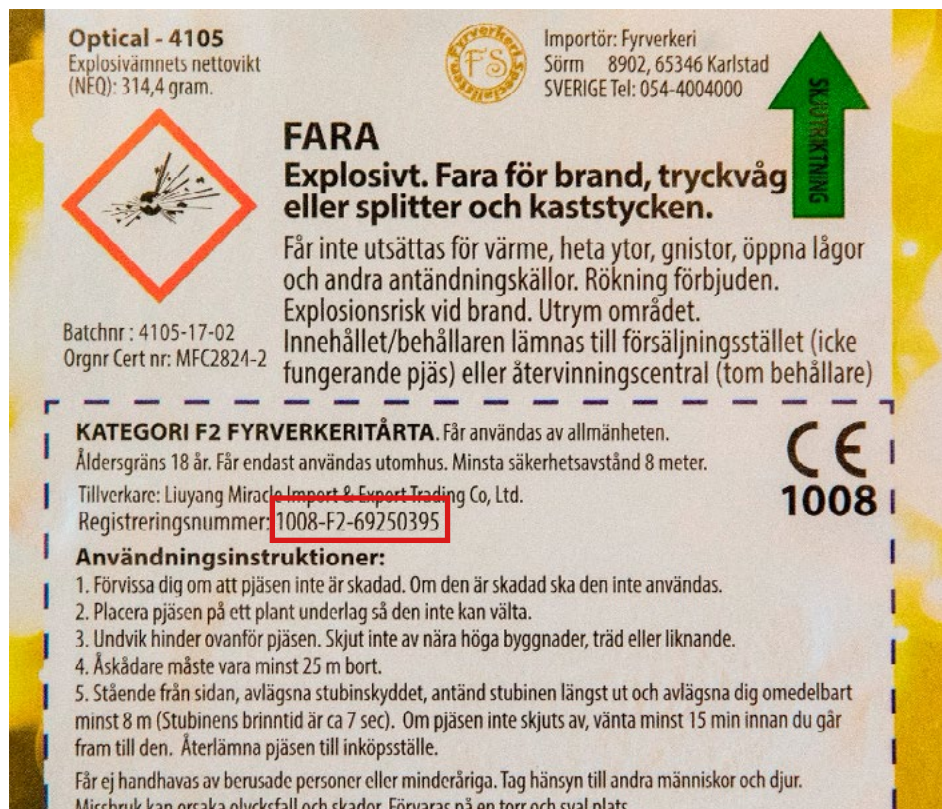
Bild 21: Exempel på märkning av pyroteknisk artikel med registreringsnumret innehållande produktens kategori inringat med röd färg.
